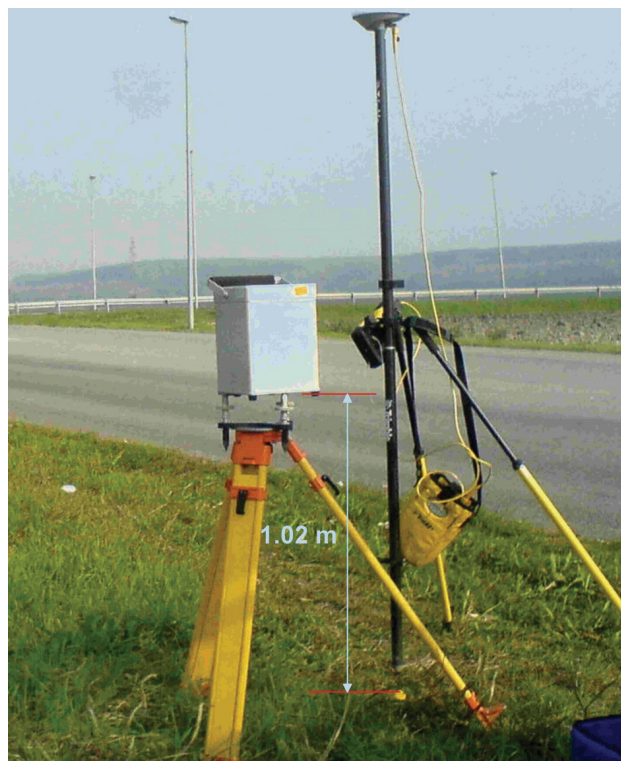
Слика 4. Мерење гравиметром на тачки означеној кочићем
