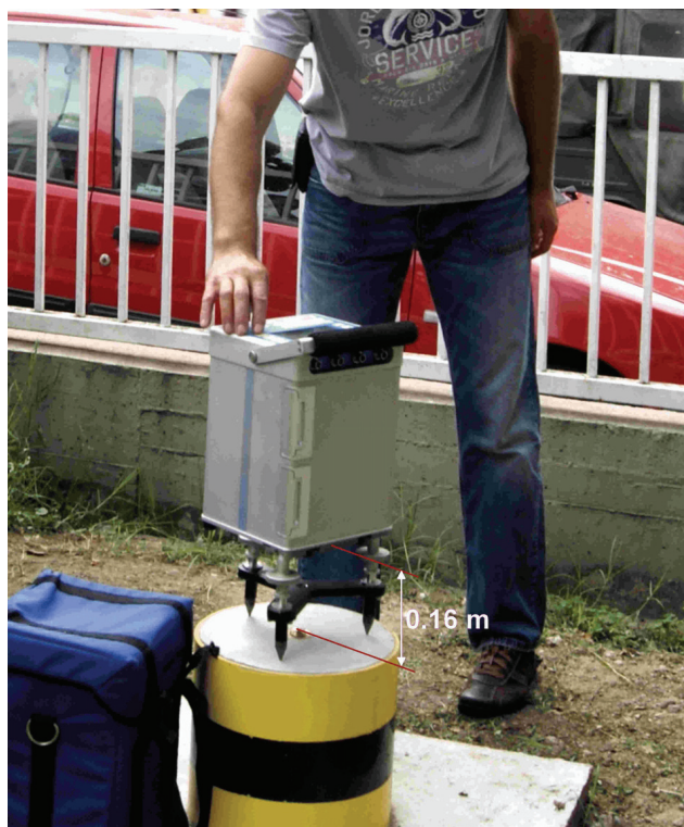
Слика 3. Мерење гравиметром на СРЕФ тачки
