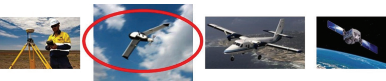
Слика 3. БАС попуњавају простор између терестричких метода и аерофотограметрије
